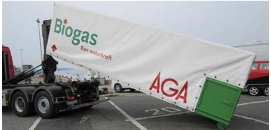
Déchargement d'un CGEM d'un camion à l'aide d'un bras de levage hydraulique à crochet
