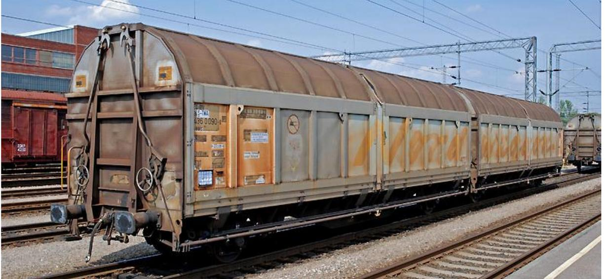
**Abb. 4:** Beispiel 3 für eine Einheit bestehend aus einer Gruppe aus dauerhaft verbundenen Elementen, die nicht getrennt voneinander betrieben werden können (Selbstentladezug)
