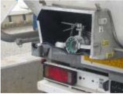
Image 3 : Gros plan sur le boîtier d'accessoires déformé
