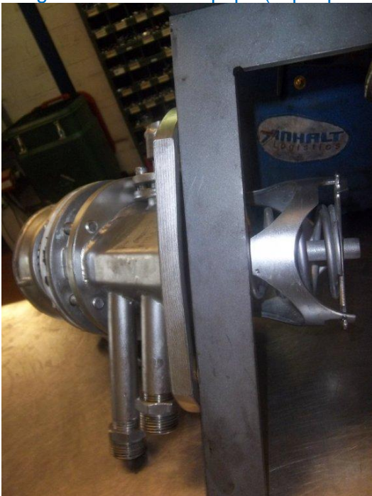
Image 5 : Unité de soupape (la plaque de fixation est bombée)
