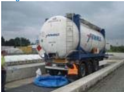
Image 2 : Conteneur-citerne dans le bac de rétention le lendemain
