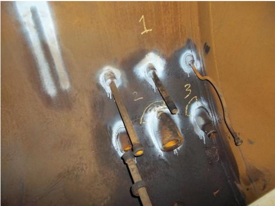
Aufgrund dieser ersten Anzeichen wurde die Oberfläche leicht abgeschliffen, um sicherzustellen, dass es sich nicht nur um ein Überlappen von Schweißnähten handelte. Dabei wurde jedoch bestätigt, dass es sich in allen drei Fällen um Haarrisse handelte (mit der weißen Hintergrundfarbe und dem schwarzen Indikator wird dies auch für das bloße Auge sichtbar).
