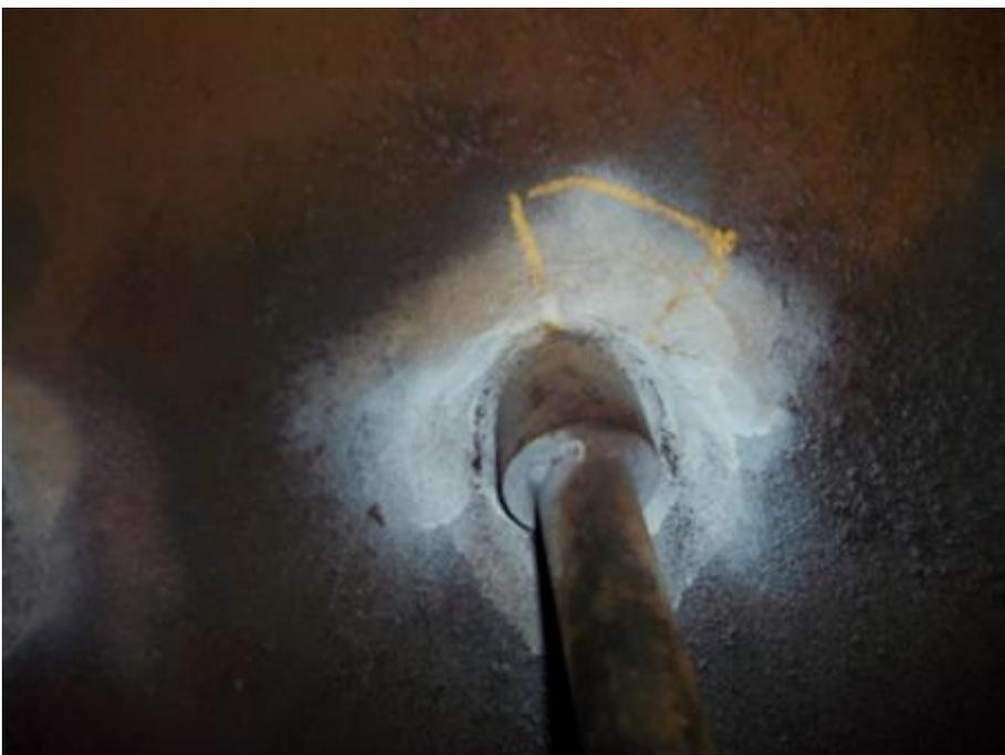
Stutzen 2 ist die Verbindung zum Befüllen des Kesselwagens (Verbindung zum internen Rohrleitungssystem) und weist, wie unten dargestellt, einen 90 mm langen Riss auf:
