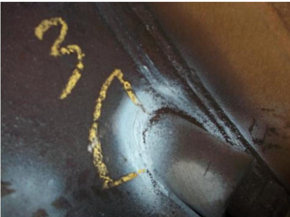
Die Magnetpulverprüfung einer Schweißnaht (1995 als Teil des Prüfverfahrens eines Unternehmens beim Kauf eines 1973 von einem namhaften Tankhersteller gebauten gebrauchten festverbundenen Tanks durchgeführt) entlang eines Teils des Verbindungsstutzens des Hauptablaufs ergab, dass die interne Nahtwurzelschweißung fehlte und lediglich eine Decknaht vorhanden war.
