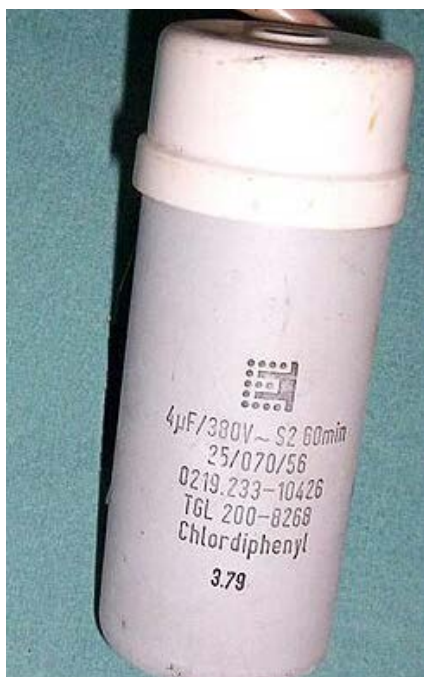
Condensateur contenant des PCB
