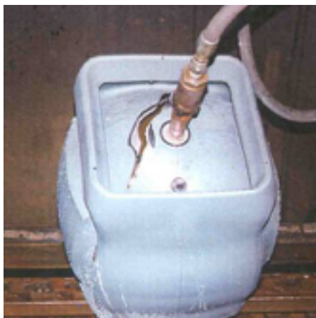
Exemple d'essai d'éclatement
