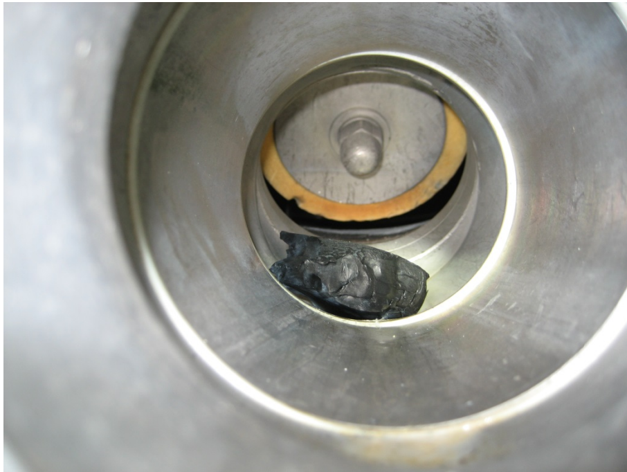
Image 1 : Corps étranger dans la sortie de fond
