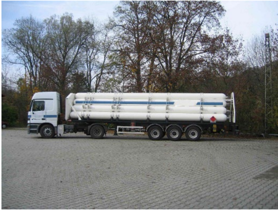
Batterie-Fahrzeug mit Großflaschen aus nahtlosem Stahl
