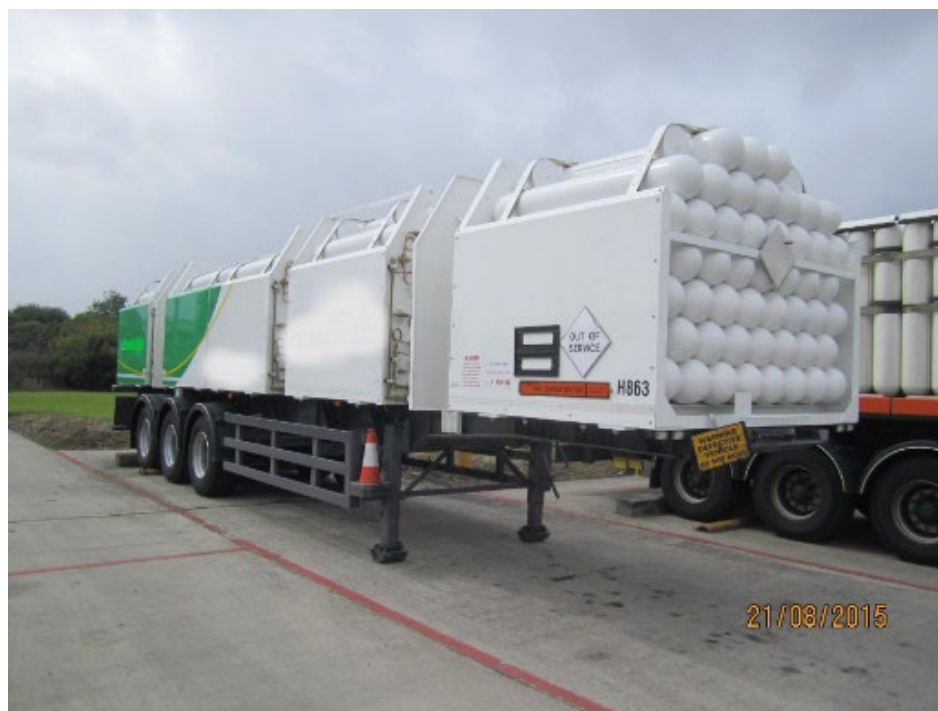
Batterie-Fahrzeug mit Flaschen aus nahtlosem Stahl
