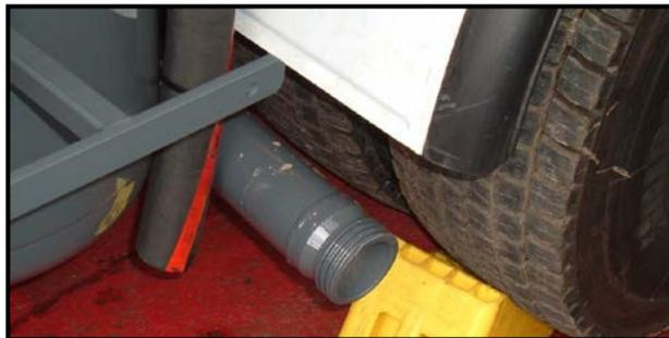
7. Es wird eine flexible Leitung angeschlossen, die die Dämpfe entweder (a) zu einem ortsfesten Gerät leitet, das den Ausstoß der Vakuumpumpe reinigt, oder (b) in einen ca. 15 m langen Verlängerungsschlauch abführt, der eine Ableitung der Dämpfe an einen sicheren Ort (d. h. fernab von potenziellen Gefahren, Zündquellen und Personal) ermöglicht. Ein Beispiel für eine solche Konstruktion im Betrieb ist nachfolgend dargestellt:
