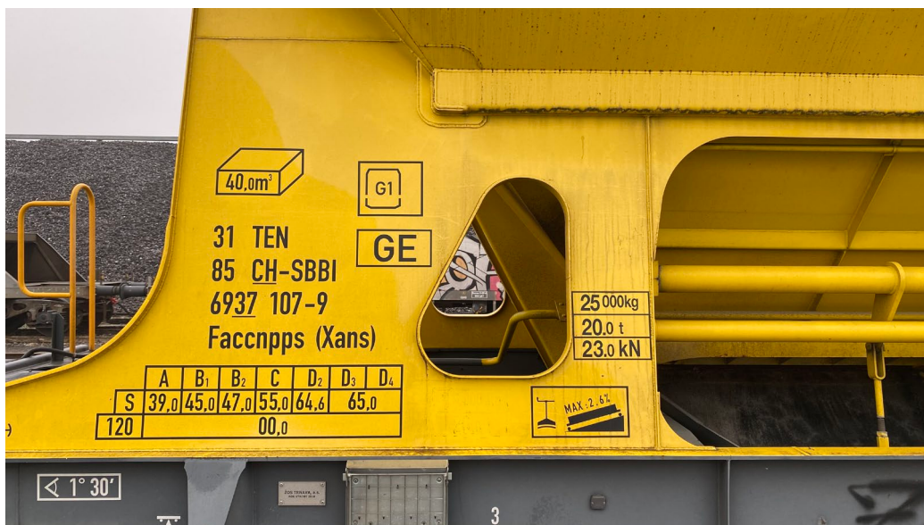
Bild 3: Kennzeichen an einem Güterwagen, der die „GE“-Anforderungen erfüllt
