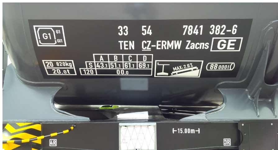
Bild 2: Kennzeichen an einem Güterwagen, der die „GE“-Anforderungen erfüllt
