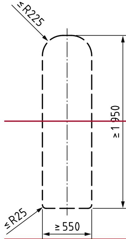
*Figure J3 – Profil minimum du couloir depuis les places pour fauteuils roulants et jusqu'à celles-ci*
