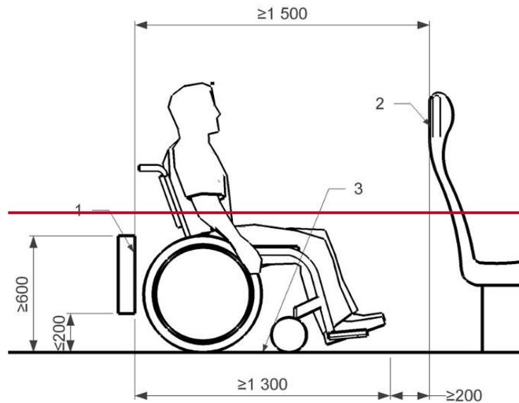
*Figure 13—Deux places pour fauteuil roulant en vis à vis*
