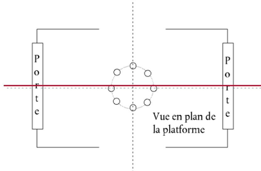
~~Méthode de mesure à l'extérieur pour les avertissements sonores des portes de voitures « voyageurs » (ouverture et fermeture)~~
