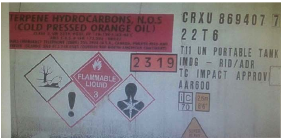
Exemples de citernes mobiles sur lesquelles apparaissent des marques du SGH aux côtés d'une plaque-étiquette de la classe 6.1 et d'une plaque-étiquette de la classe 3
