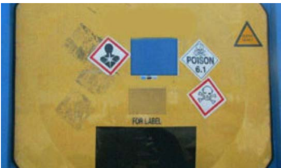
Exemples de citernes mobiles sur lesquelles apparaissent des marques du SGH aux côtés d'une plaque-étiquette de la classe 6.1 et d'une plaque-étiquette de la classe 3
