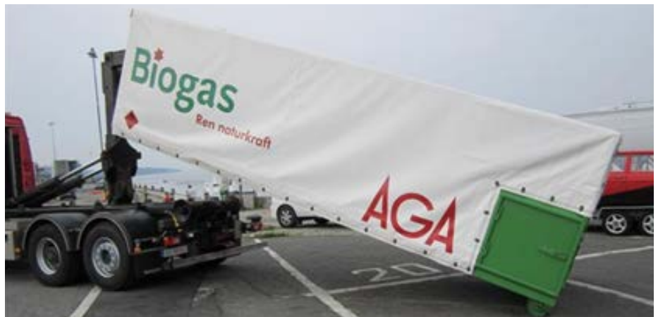
MEGC, der mit Hilfe eines Hakenlifts von einem Lastwagen entladen wird
