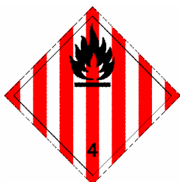
(Nr. 4.1) Symbol (Flamme): schwarz auf weißem Grund mit sieben senk- rechten roten Streifen; Ziffer «4» in der unteren Ecke
