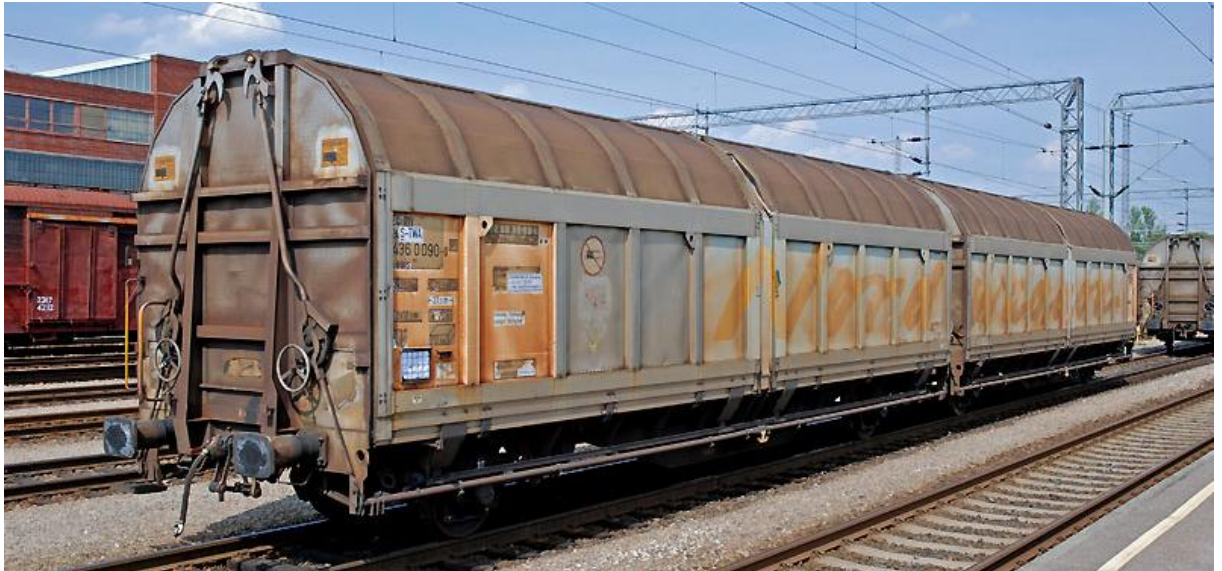
Figure 3 : Exemple 2 d'unité composée d'une rame constituée de deux éléments connectés de façon permanente et ne pouvant pas être exploités séparément
