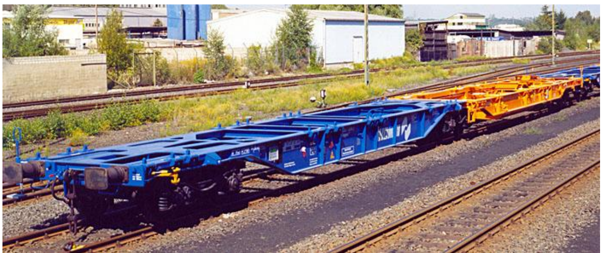
Figure 2 : Exemple 1 d'unité composée d'une rame constituée de deux éléments connectés de façon permanente (un bleu et un orange) et ne pouvant pas être exploités séparément (wagon articulé)
