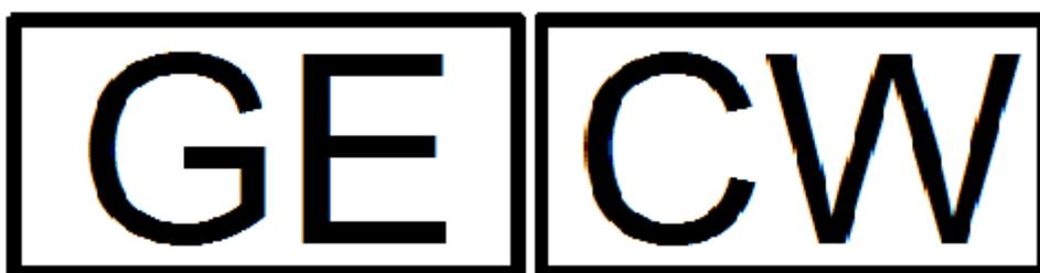
Les lettres doivent être dans la même police de caractères que le marquage RTE. Tous les chiffres et lettres doivent avoir au moins 100 mm de hauteur. Les dimensions extérieures du cadre doivent être d'au moins 275 mm de large et 140 mm de haut, et le cadre doit avoir une épaisseur de 7 mm.
