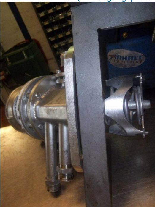
Bild 5: Ventileinheit (Befestigungsplatte ist gewölbt)
