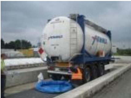
Bild 2: Tankcontainer in der Auffangwanne am nächsten Tag
