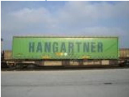
Bild 7: Beispielfoto – Trailerverladung auf einem "Taschenwagen"
