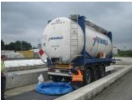
Bild 2: Tankcontainer in der Auffangwanne am nächsten Tag
