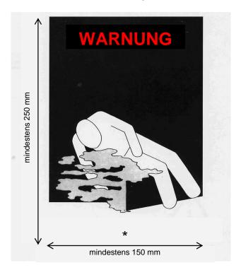
\* Die in Kapitel 3.2 Tabelle A Spalte 2 angegebene Benennung, gefolgt von dem Ausdruck «ALS KÜHLMITTEL» bzw. «ALS KONDITIONIERUNGSMITTEL», einfügen.
