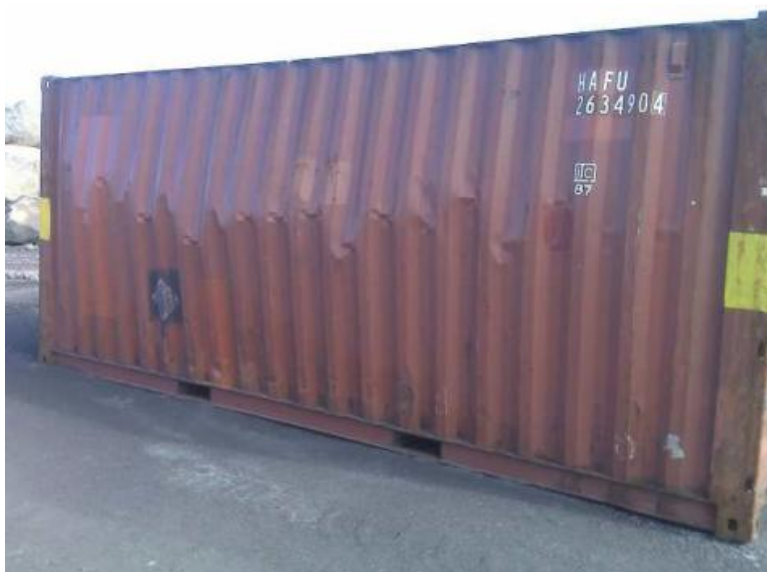
Abbildung 1: Wegen Druckaufbaus beschädigter geschlossener Container mit Krätzerückständen
