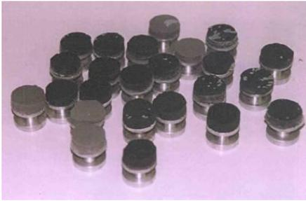
Beispiele von Blöcken mit extrahierter Polyurethanschicht (Haftfestigkeitsprüfung)
