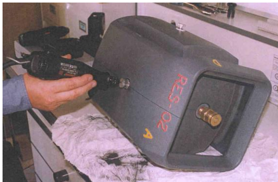
Beispiel einer Haftfestigkeitsprüfung
