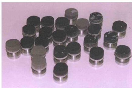
Beispiele von Blöcken mit extrahierter Polyurethanschicht (Haftfestigkeitsprüfung)
