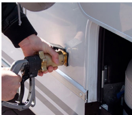
Befüllung einer fest eingebauten Flüssiggasflasche
