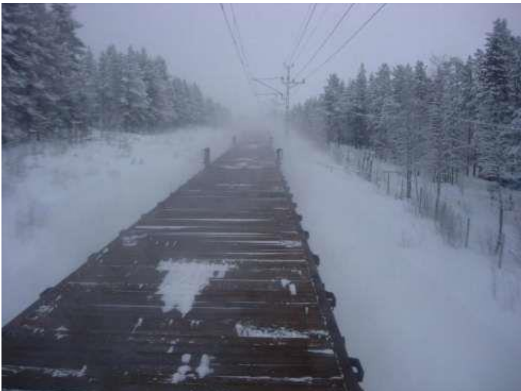
Abbildung 11: Winterprüfung (Schneehöhe 2 bis 3)
