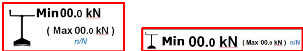
Figure 3 : Marquage de la force du frein de stationnement
