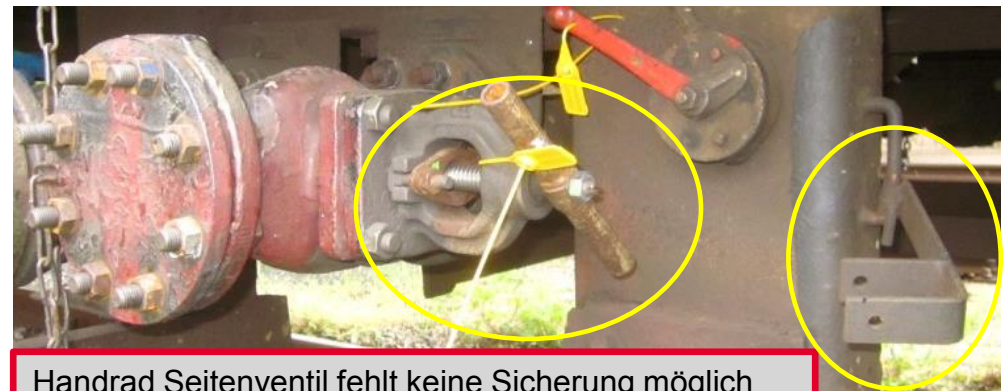
Verriegelung BV an Wagenunterseite angebracht, Stellung nicht angeschrieben und in Entriegelt-Stellung plombiert
