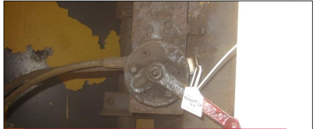
Verriegelung BV an Wagenunterseite angebracht, Stellung nicht angeschrieben und in Entriegelt-Stellung plombiert
