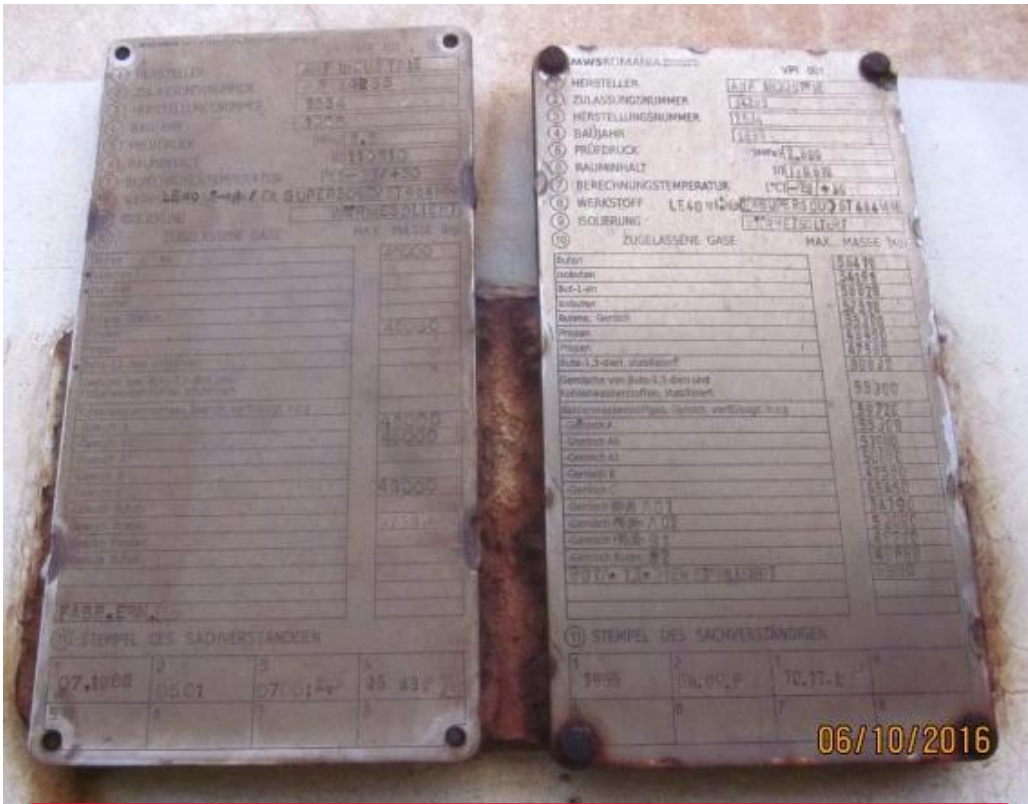
Flüssiggaskesselwagen mit 2 unterschiedlichen Tankschildern
