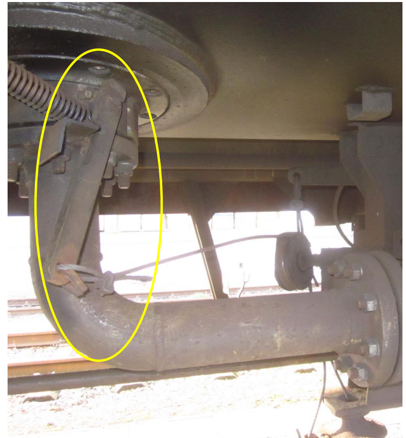
AUXIM Bodenventil Gasphase ohne Verriegelung
