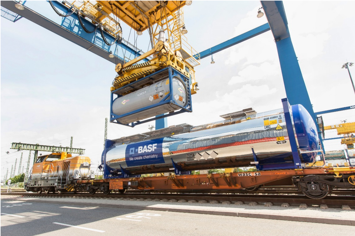
Image 1 : B-TC monté sur un wagon, comparé à un conteneur-citerne de 20 pieds
