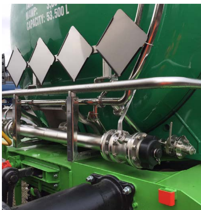
Image 4 : Gros plan sur un fond de citerne avec équipement de service au-dessus des tampons (CFF Infrastructure, 8.11.2017)
