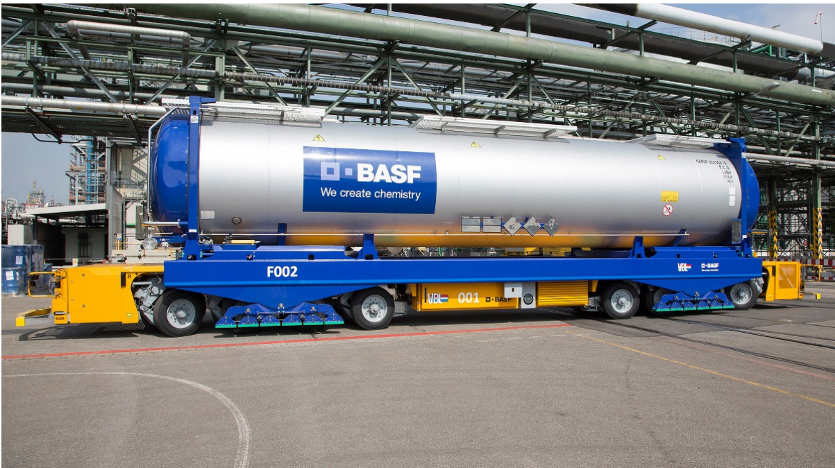
Image 2 : Au sein des sites industriels, le B-TC peut être transporté sur des véhicules autoguidés.
