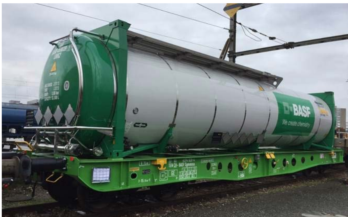
Image 3 : B-TC sur wagon porteur spécialement conçu (CFF Infrastructure, 8.11.2017)
