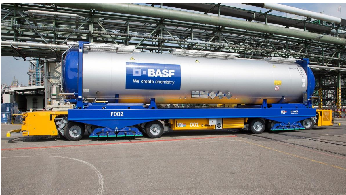
Bild 2: Innerhalb des Industriestandortes können B-TC durch autonom fahrende Fahrzeuge befördert werden.
