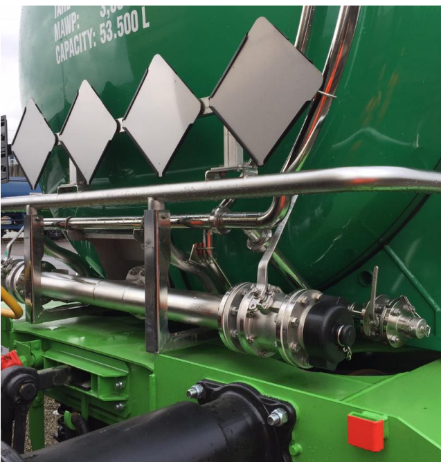
Bild 4: Nahaufnahme einer Stirnseite mit Bedienungsausrüstung über den Puffern (SBB Infrastruktur, 08.11.2017).
