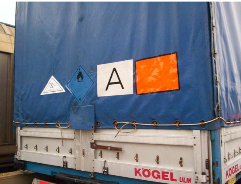
Abbildung 4: Sattelaufleger. Die nach dem ADR vorgeschriebene Kennzeichnung ist sichtbar.
