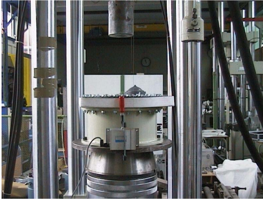
Photo 1 Dispositif d'épreuve quasi istatique
