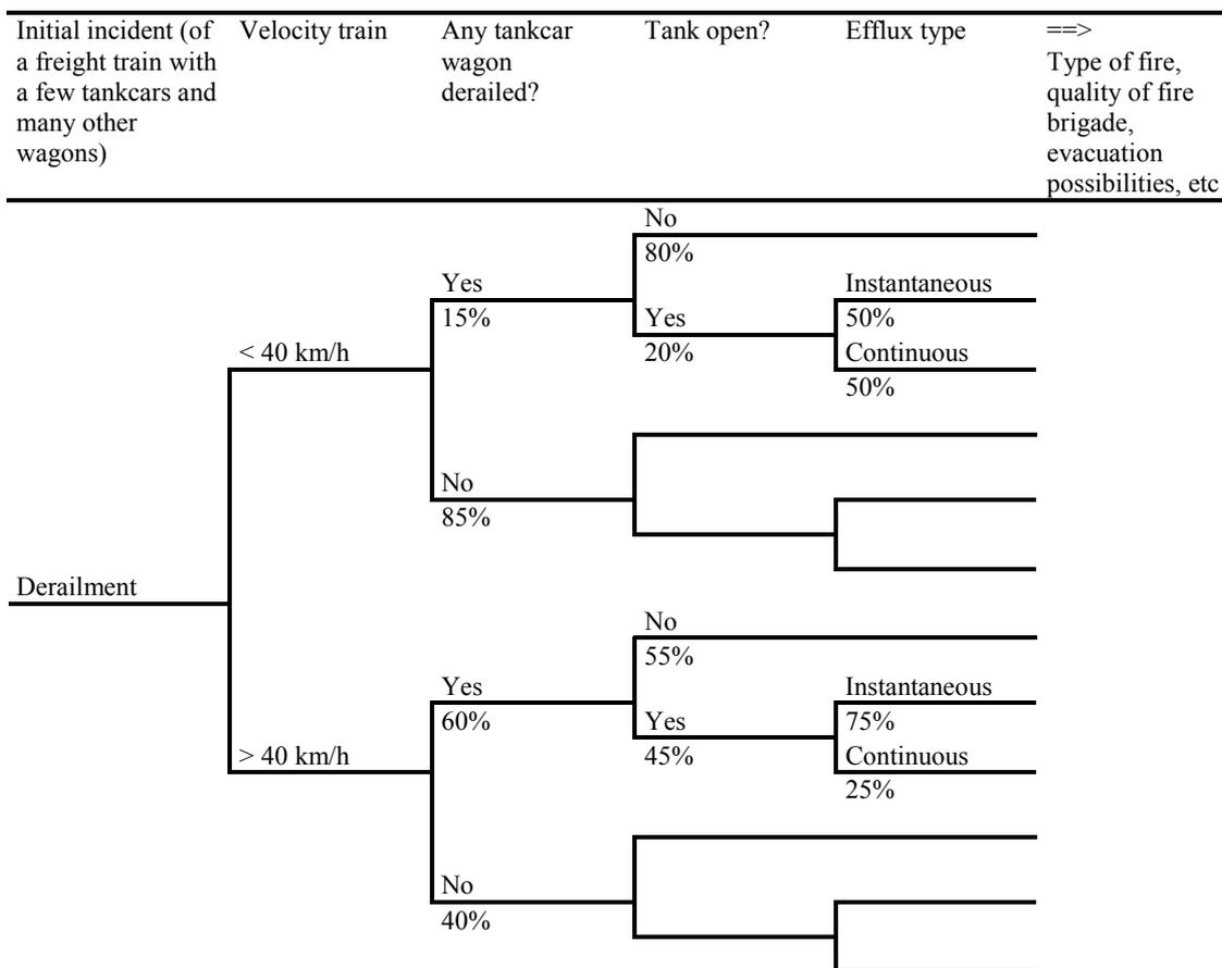
**Abbildung 3:** Beispiel für einen Teil eines Ereignisbaums für einen Eisenbahnkesselwagen zur Beförderung entzündbarer flüssiger Stoffe. Die quantitativen Werte sind willkürlich.
