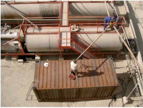
Beladen des Containers mit Bitumen
