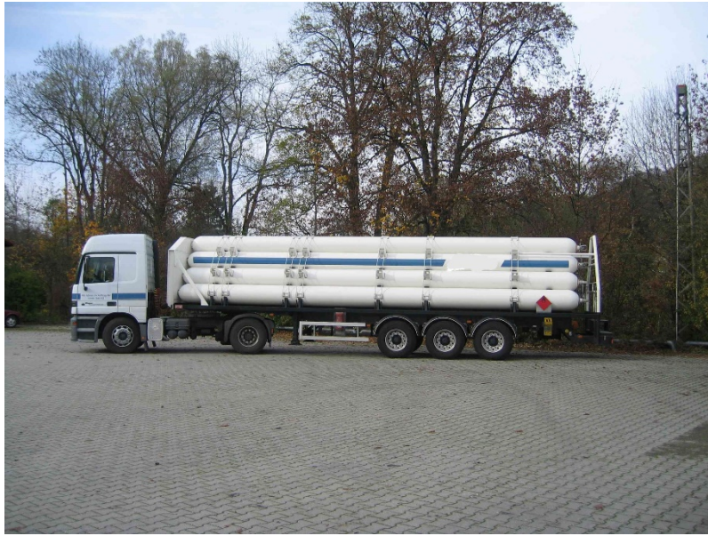
Batterie-Fahrzeug mit nahtlosen Großflaschen aus Stahl
