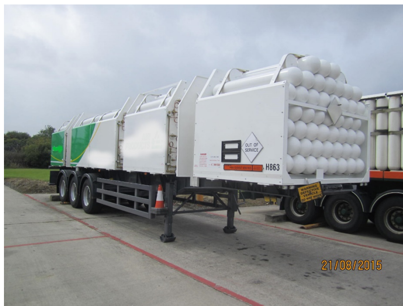
Batterie-Fahrzeug mit nahtlosen Flaschen aus Stahl
