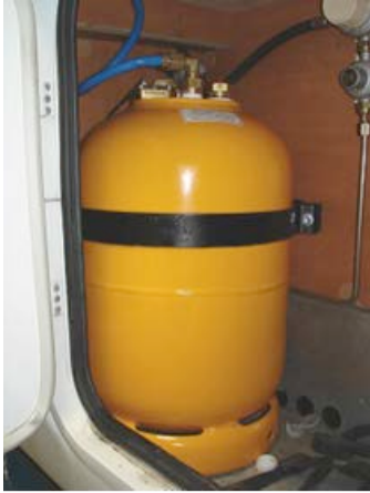
Abbildung 3: Befüllung einer fest eingebauten Flasche
