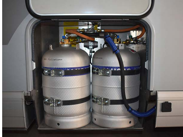
Abbildung 3: Befüllung einer fest eingebauten Flasche
