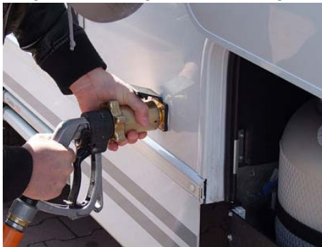
Abbildung 3: Befüllung einer fest eingebauten Flasche
